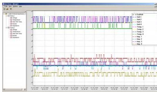
BACS-Batterieanalyse für 4 Akkus mit BACS VIEWER. Jede Veränderung in der Impedanz, Temperatur, Volt und Bypass wird alle 30 Sekunden aufgezeichnet.
