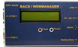
Der BACS WEBMANAGER verwaltet bis zu 190 Batterien, eine USV sowie bis zu 8 zusätzliche Umgebungssensoren.
