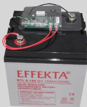
Modul C004 auf Batterie BTL6-100
