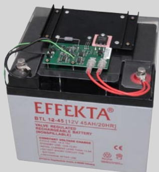
Modul C003 auf Batterie BTL12-45
